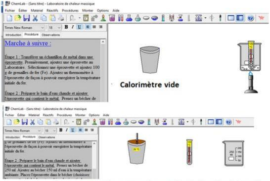
Calorimètre + 100mL d'eau +100g de grenaille de fer T (finale) = 28° C
