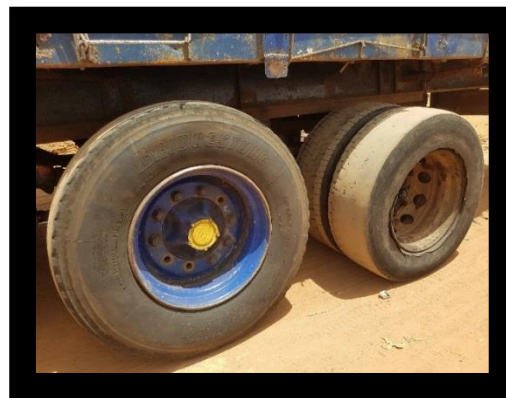
Photos 5 : Mauvais état des roues du camion
